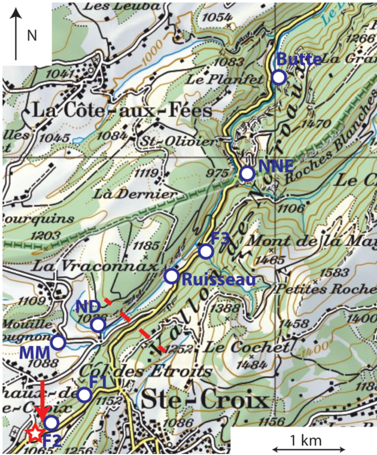
Fig. 1: Carte de situation. Etoile rouge: décharge. Flèche rouge: déversement des traceurs au pied de la décharge. Cercles bleus: points d'échantillonnage de l'essai de traçage (F1, F2 et F3: forages profonds, MM: Source de Mouille-Mougnon, ND: source Noirvaux dessus, NNE: source non captée Noirvaux-Neuchâtel, Butte: source de la Longeigue du village de Butte. Traitillé rouge: profil géologique de la figure 2. Reproduit avec l'autorisation no JA110138 de Swisstopo.
