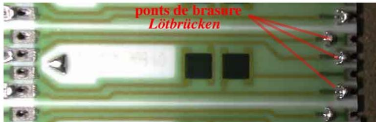
Figure 1-1. Ponts de brasure sur la poutre, face supérieure.
