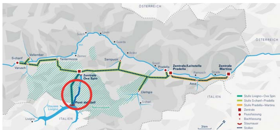
Bild 2. Übersicht der Anlagen der Engadiner Kraftwerke AG, die Restwasserstrecke des Spöls führt vom Stausee-Livigno bis zum Ausgleichsbecken Ova Spin (rot markiert) durch den Schweizerischen Nationalpark (schraffiert).
