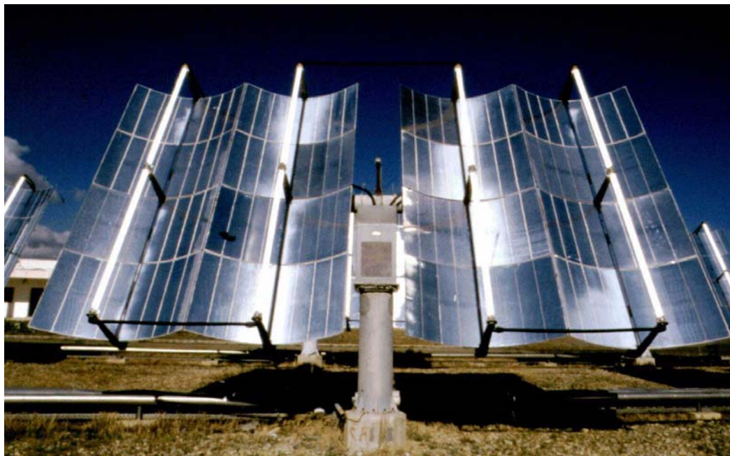
FIGURE 5.5 The Parabolic-Trough Concentrator at the Plataforma Solar de Almería.
