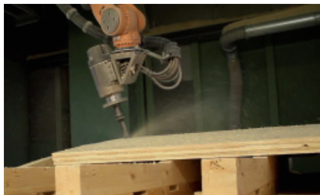
Bild 3. Automatische Herstellung der Schwalbenschwanzzinkung mithilfe eines Industrieroboters Fig.3. Automatic fabrication of the dovetail joints with an industrial robot
