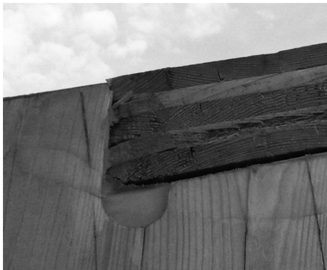
Bild 7. Delaminierung der Klebeflächen parallel zur Kante Fig. 7. Delamination of the contacts parallel to the edge
