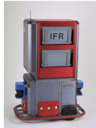
Fig. 3: Helpmate, ein Roboter der in Spitälern Transportaufgaben übernimmt.
