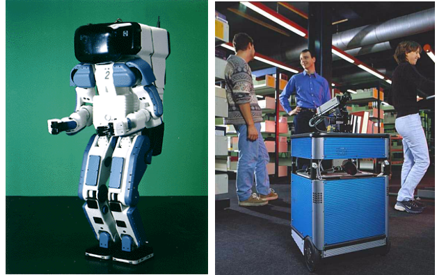
Fig. 1: Soll das Design eines mobilen Roboters sich eher am Menschen (Humanoider Roboter von HONDA) oder an der Aufgabe (Pygmalion, Büroautomatisierung, EPFL) orientieren?
