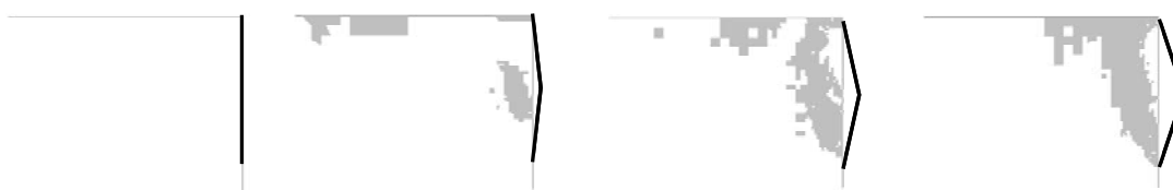
Figure 5.9: Plastification progressive du sol derrière la paroi (zones plastiques déterminées par le logiciel Z_soil)
