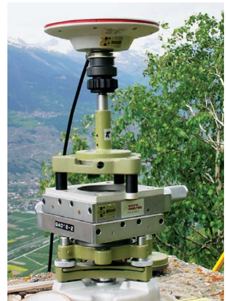
Fig. 4: Montage de l'antenne pour le test de détection de mouvements.
