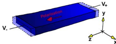
Fig. 2.6: The longitudinal vibration mode
