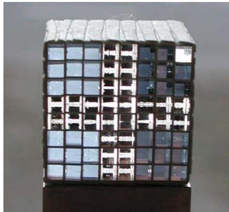
FIG. 2.9 – Matrice phoswich LSO/LuYAP comportant 9 LSO aluminisés à 30 nm (en haut à gauche), 9 LuYAP aluminisés à 30 nm (en bas à gauche), 8 LSO aluminisés à 45 nm (en haut à droite) et 9 LuYAP aluminisés à 45 nm (en bas à droite). Les pixels formant la croix centrale comportent des inserts de Mylar aluminisé découpés au laser.
