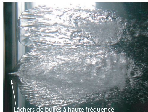
Figure 6.4 – Cohabitation, sur le profil Naca 65012, d'une poche de cavitation lisse due au décollement laminaire et d'un "spot" initié par la nucléation de surface sur une indentation placée artificiellement sur le bord d'attaque du profil ( C = 11 \text{ m/s} , \alpha = 4 , \sigma = 1.1 )
