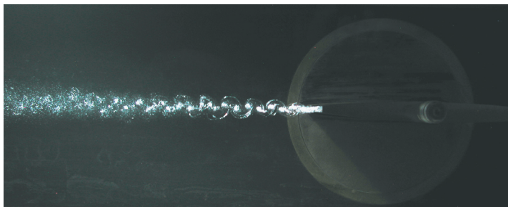
Figure 5.3 – Allée tourbillonnaire de Von Karman générées au bord de fuite du profil Naca 0009. Visualisation des vortex par la présence de vapeur.
