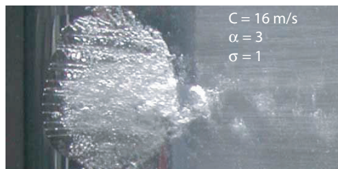
Figure 6.2 – Figure de cavitation sur le profil Naca 0009 poli-miroir
