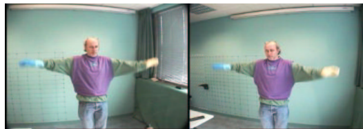
FIG. 3 – Images droite et gauche d'une personne présentant une extension maximale des bras. Les deux caméras avec un champ de 70^\circ sont à 1,60m du sol et distantes de 1,20 m ; la personne est située à 1,90 m des deux caméras.
