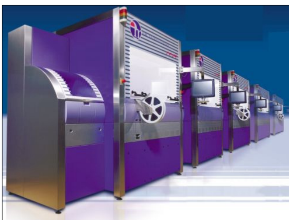
Fig. 1: Un exemple d'un mini-environnement propre et modulaire pour l'assemblage des MEMS par MA3-MST/MEMS Technology
