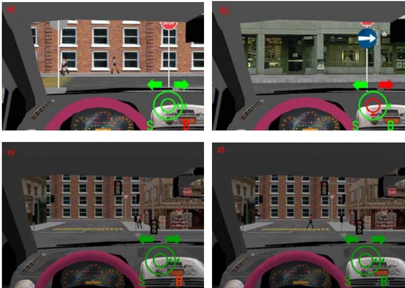
*Figures 6-23a) à 6-23d). Les senseurs virtuels et le modèle comportemental de conduite de la voiture. Un piéton souhaite traverser la rue selon les règles définies. L'interface informe le conducteur qu'il doit freiner (B – en rouge dans l'angle inférieur droit de la Figure 6-23a) et 6-23c)). Le pilote et le co-pilote sont indiqués au moyen des deux grands cercles verts.*
