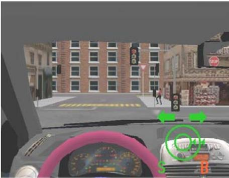
*Figure 4-17. Pilote "voyant" les feux de circulation et le piéton à l'intérieur d'une zone circulaire. L'AAV, qui a appris le comportement, l'informe, au moyen de ses indicateurs, qu'il doit freiner (B pour "brake" est inscrit en rouge, en bas à droite de la figure).*
