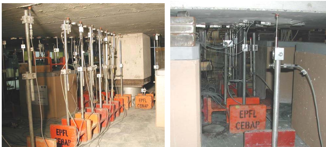
Figure D-3.16: Capteurs inductifs. A gauche : grande dalle PG-3, à droite : petites dalles
