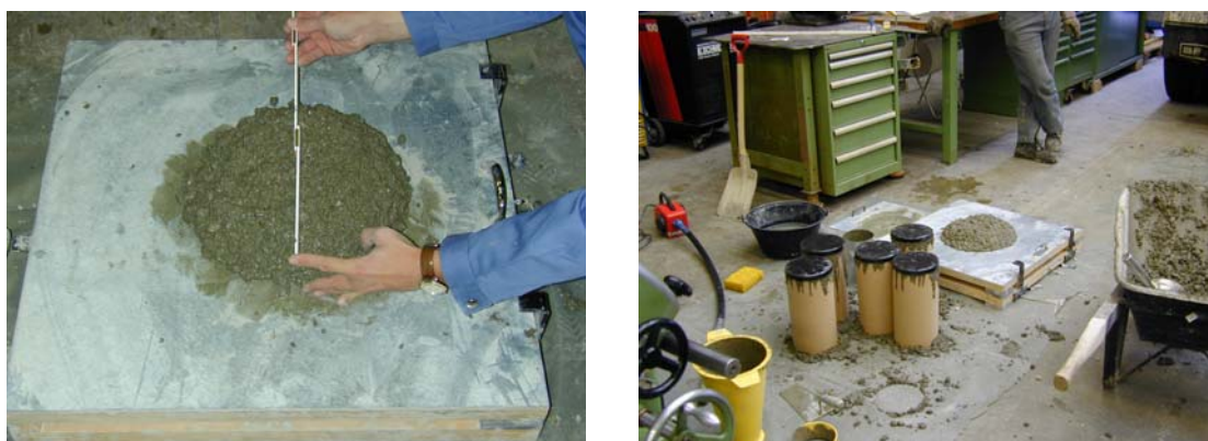
Figure D-2.7: Essais sur béton frais (gauche) et cylindres (droite)
