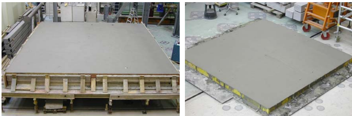
Figure D-2.9: Dalles après bétonnage; à gauche : PG-3; à droite : PG-6 à PG-9
