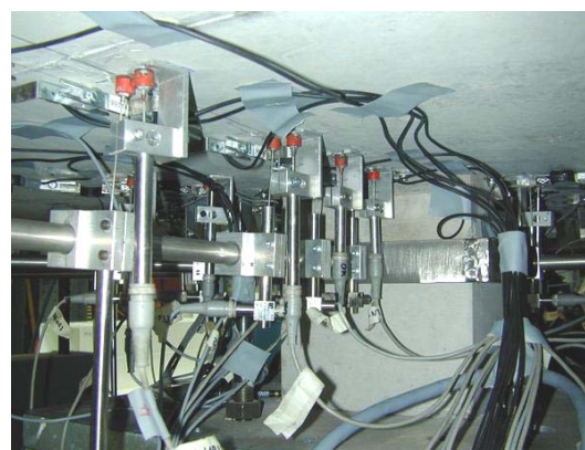
Figure D-3.31: Détail de la fixation des capteurs inductifs à la face de la dalle
