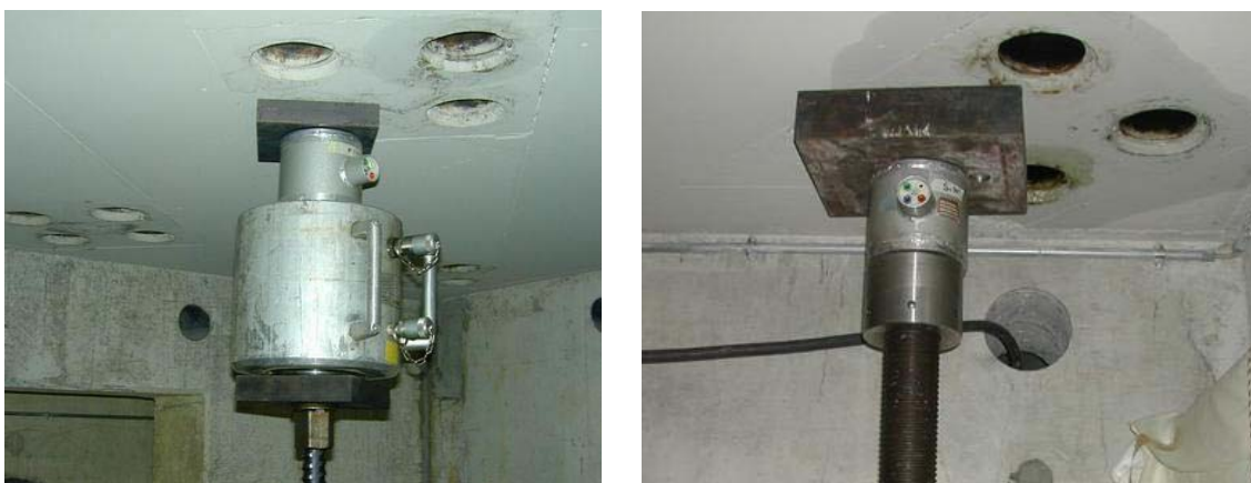
Figure D-3.10: Capteurs de force. A gauche entre une plaque métallique et un vérin (dalles de 3 m et de 1.5 m) ; à droite entre une plaque métallique et une écrou de la tige Macalloy (dalle de 6 m)
