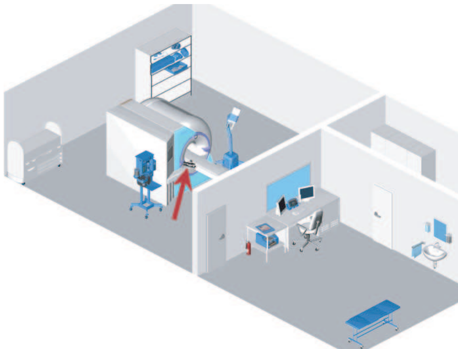
FIG. 7.4 – Une salle d'imagerie par résonance magnétique se compose de la chambre d'étude magnétiquement blindée où se trouve le scanner, et de la salle de contrôle [85]. La flèche à l'entrée du scanner indique la position typique de l'interface haptique.
