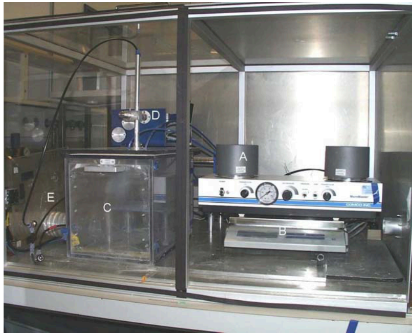
FIG. 2.1: Montage expérimental utilisé : A sableuse Comco, B balance Mettler, C chambre de sablage, D moteurs reliés à la buse, E tuyau de l'aspirateur.
