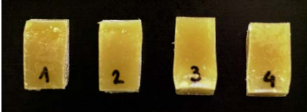
Figure 24 PU compression specimens after « failure »
