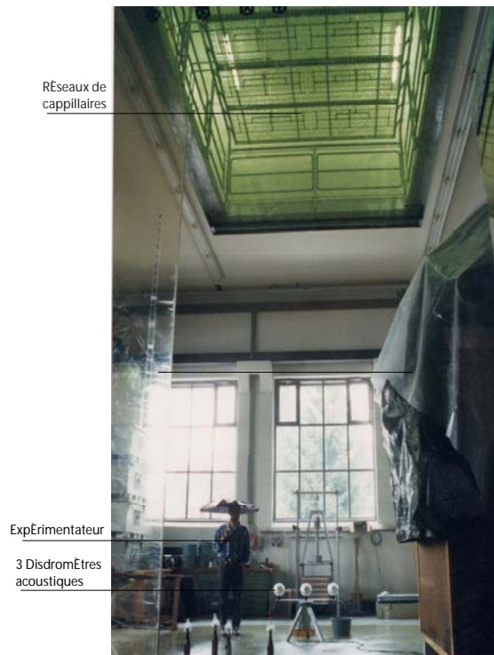
FIG. 3.13.: Photo de l'installation des expériences sous simulateur de pluie
