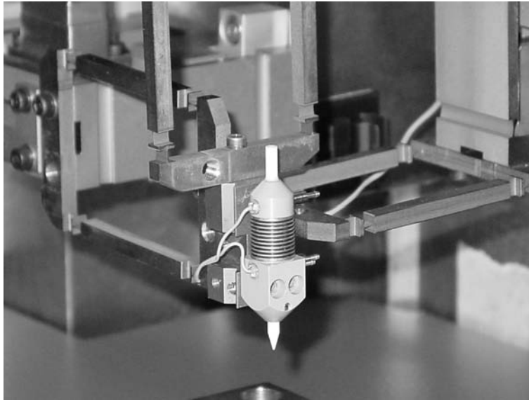
Figure 8.11: Les bras des parallélogrammes du troisième prototype avec un dispositif d'avance électrode monté sur la sortie.
