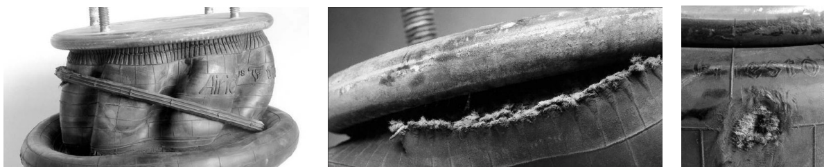
Bild 225: Beispiele von Defekten bei Luftfederungen (Firestone Airide Air Springs Maintenance Manual)
