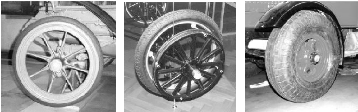
Bild 207: Entwicklung bei Reifen; links: Vollgummirad, frühe 1920er Jahre, Mitte: demontierbares Kfz-Rad, um 1900, rechts: frühes Luftreifenrad eines Nutzfahrzeugs („Riesenlufttrad“), 1930 [Zima 2002]
