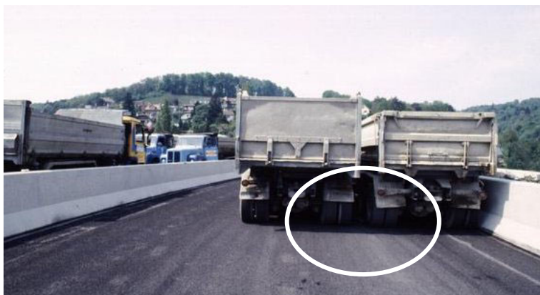
Bild 175: Beanspruchung einer Fahrbahnplatte durch zwei eng stehende Fahrzeuge (Foto eines Belastungsversuchs mit freundlicher Genehmigung des IS-Beton, EPFL)
