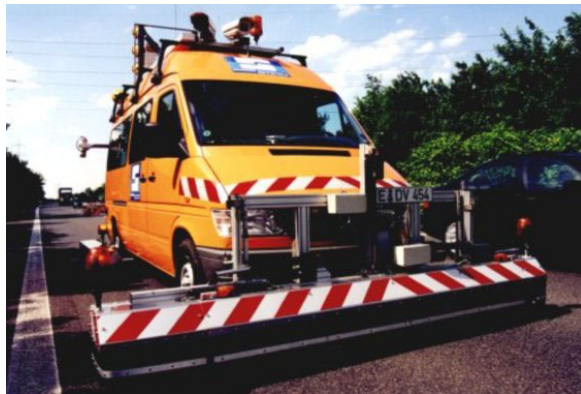
Bild 264: System zur Erfassung der Ebenheit der Fahrbahnoberfläche (Schniering Ingenieurgesellschaft mbH www.schniering.com )
