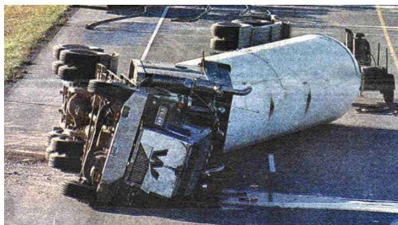
Bild 193: Zustand der Achsen nach einem Unfall durch Umkippen
