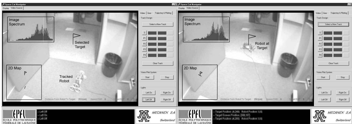
Figure 7.7: interface de commande automatique de la trajectoire de Space Cat à travers une caméra vidéo
