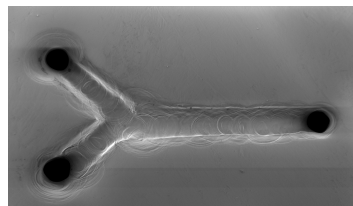
FIGURE X.15 Microréacteur en forme de y usiné par SACE . Le diamètre des trous est de 200 \mu\text{m} , la longueur des deux canaux pour l'arrivée des liquides de 1600 \mu\text{m} et la longueur du canal de mélange de 3250 \mu\text{m} .
