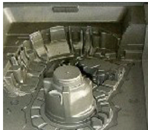
FIGURE 1. Pièce en acier trempé usinée par EDM (image Ona électroérosion 5 ).
