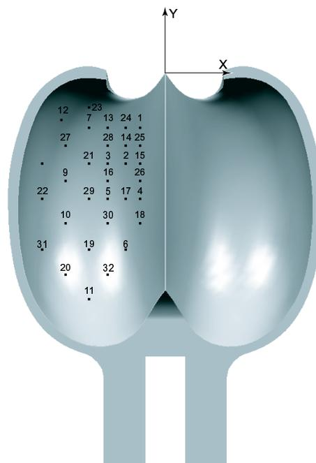
FIG. V.4.2 – Positionnement des capteurs dans l'auget
