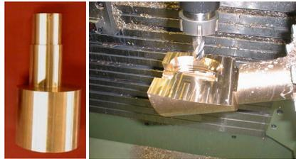
FIG. V.4.3 – Bloc de bronze initial et usinage des augets
