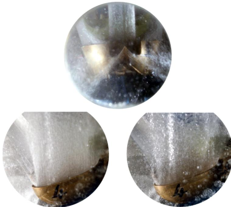
FIG. V.7.14 – Photos de l'écoulement dans l'auget,  $\gamma = 72^\circ$
