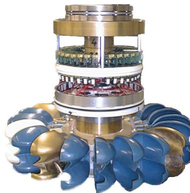
FIG. V.4.5 – Montage de la roue avec électronique de pré-conditionnement
