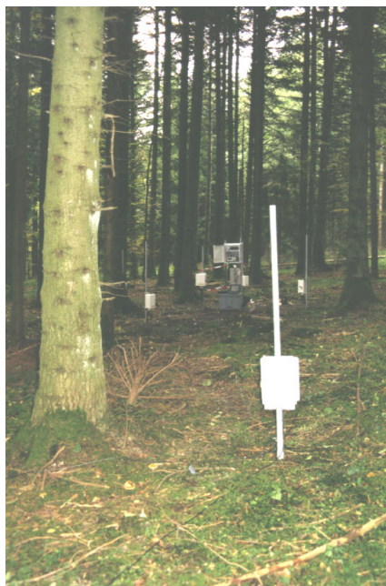
Figure 65. Vue d'ensemble du site TDR, multiplexeur au premier plan et boîtier central en arrière-plan au milieu de l'image.
