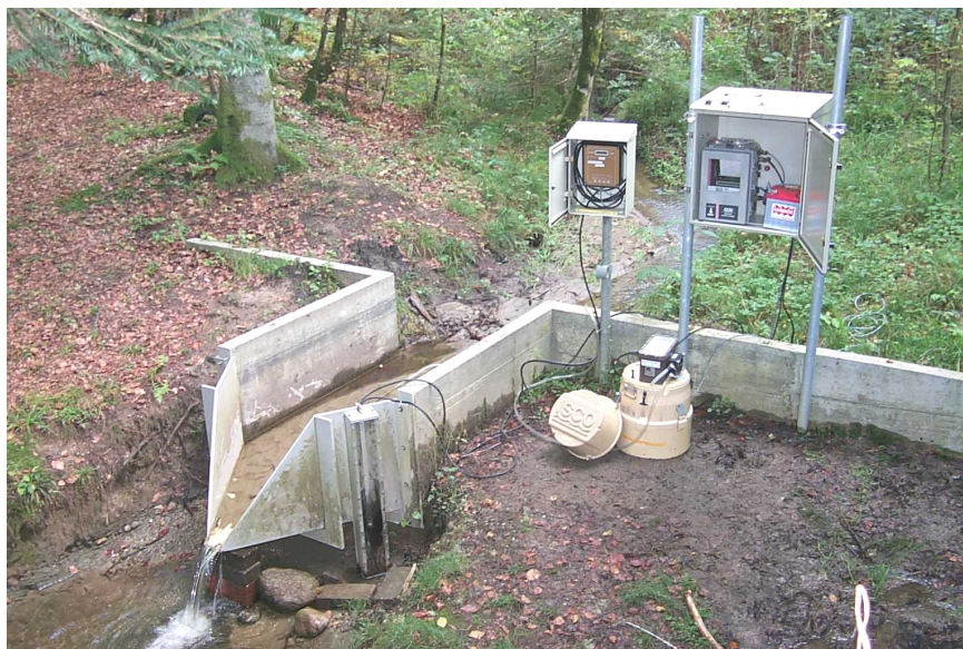
Figure 15. Station hydrométrique de Bois-Vuacoz, composée d'un ouvrage hydraulique du type H-flume, d'un débitmètre MADD et d'un équipement d'échantillonnage des eaux de rivière (débitmètre ISCO 4220 et préleveur ISCO 2900).
