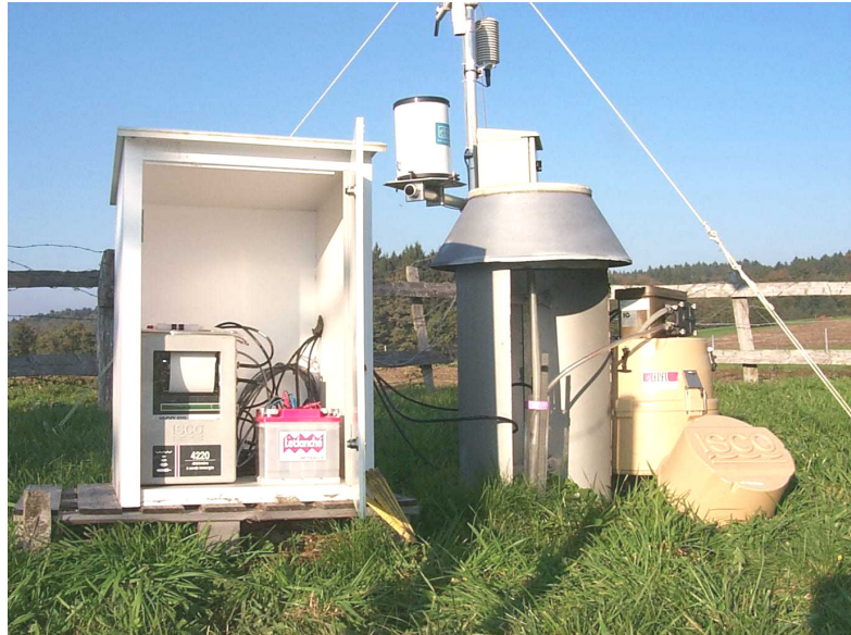
Figure 19. Système d'échantillonnage des eaux de pluie localisé à Chalet-du-Villars.
