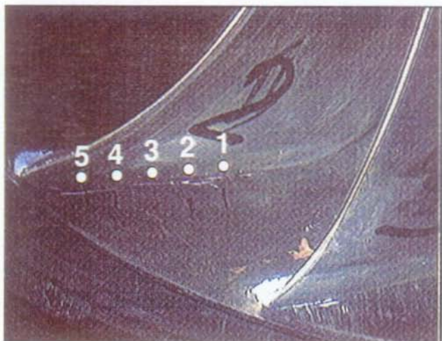
Figure III.3.6: Position des capteurs de pression instationnaire à l'extrados de l'aubage de la roue Francis
