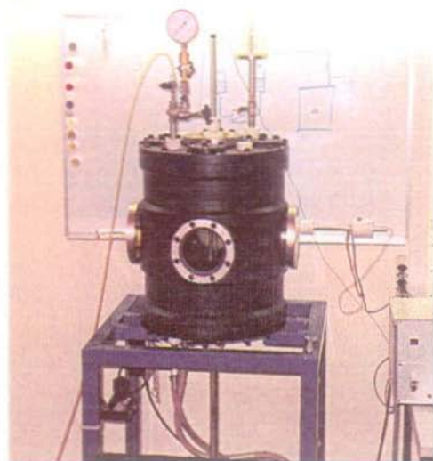
Figure III.3.11: Cuve d'étalonnage du LMH utilisée pour l'étalonnage statique et dynamique des capteurs de pression instationnaires montés sur les aubes de la roue Francis
