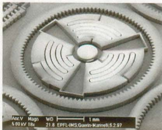
Figure 4-32 : Vue d'ensemble d'un micromoule sacrificiel, avant l'électroformage. Epaisseur du SU-8 : 220 \mu m, \phi_{ext} : 5 mm.
