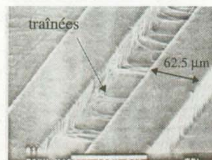
Figure 2-21 : Exposition avec une puissance de lampe de 2 \text{mW}/\text{cm}^2 , tiré de [18].
