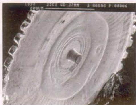
Figure 2-14 : Le rouage vu de dos montrant le premier et le second niveau. Le diamètre de l'axe est de 50 \mu\text{m} .
