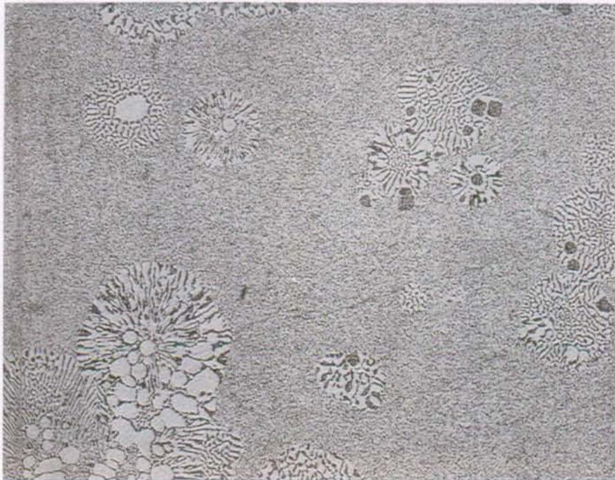
**Figure 5.3** Microstructure obtenue par la trempe d'un petit échantillon de Pb-Sn eutectique en cours de solidification (100x). L'interface solide-liquide des grains isolés est circulaire. Le globule primaire est visible au centre de certains grains. Une dendrite de la phase primaire (l'étain pour ce système, en clair sur les photographies) peut donner naissance à plusieurs grains.
