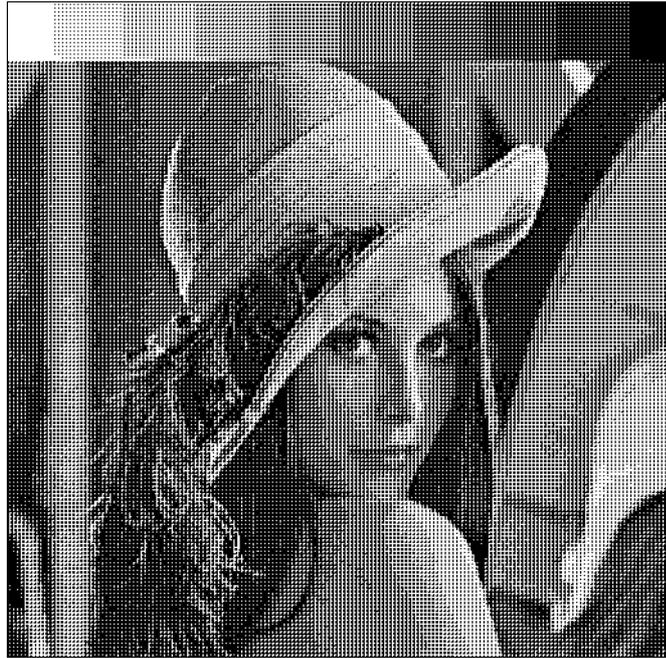
**Figure 4.15:** Matrice de seuillage  $\tau$  de taille 3x3 pixels: ( $dx_1 = 3, dy_1 = 0, dx_2 = 0, dy_2 = 3, N_s = 9$ ), ainsi qu'une image type produite à l'aide de cette matrice, sortie à 150 dpi.
