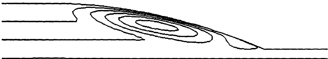
Figure 4.15: Isothermes et lignes de courant du champ de vitesse en ne tenant compte que de l'effet thermocapillaire V_{\infty} = 0.01 \text{ m/s} , \gamma_{lg} = 10. \text{ N/m} et d\gamma_{lg}/dT = -3. 10^{-4} \text{ N/m}^{\circ}\text{C} .
