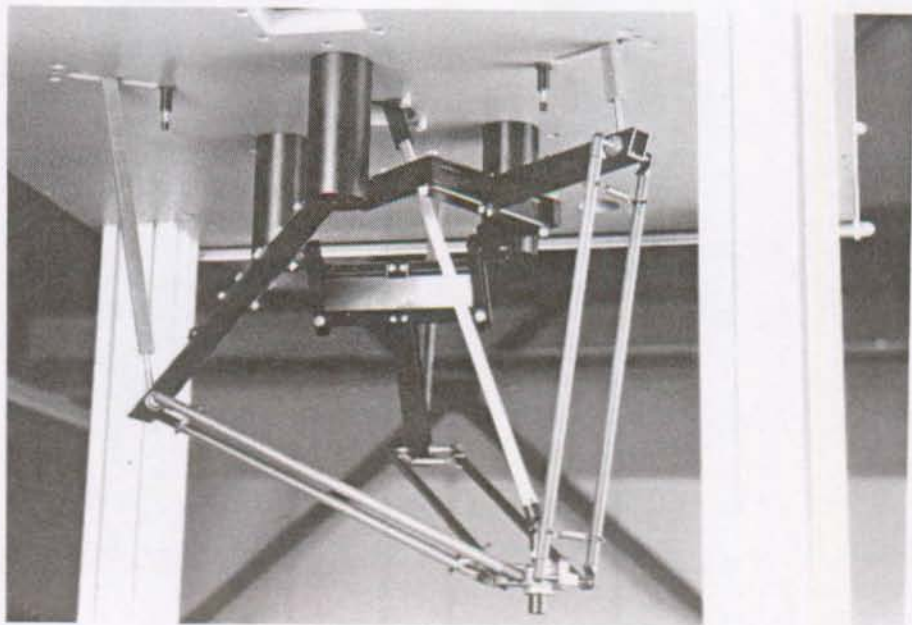
Fig.7.6 Vue de la cinématique du modèle industriel DELTA 700.
