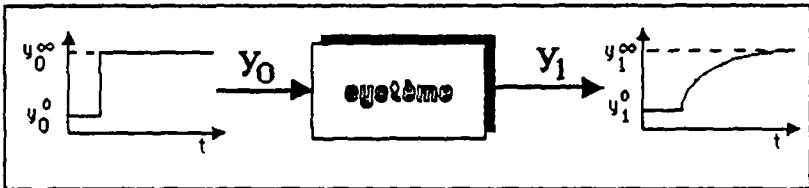
figure 3.1 : Schéma de principe d'un étage exponentiel
