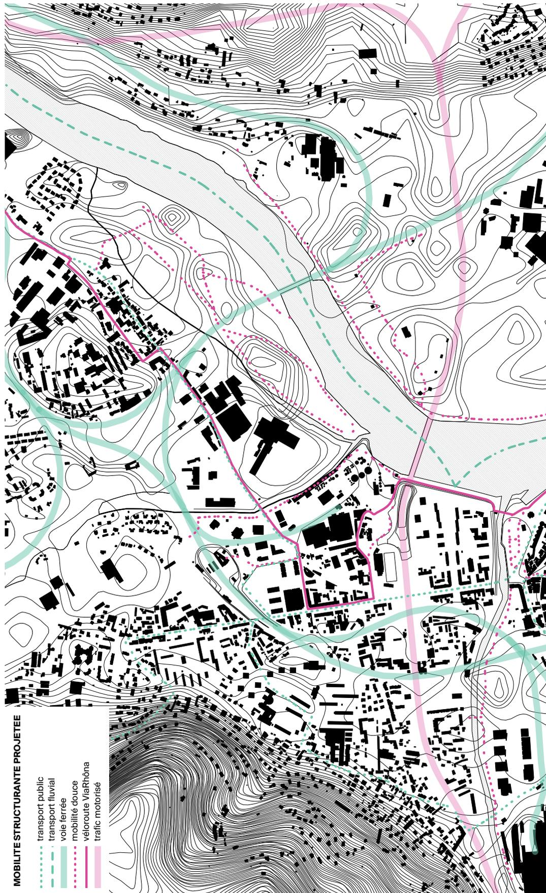
Figure 5.36 Planche analytique «Mobilité» : à terme, le réseau de mobilité givordin comportera un maillage privilégiant les connexions douces à travers le site ainsi que la potentialisation de la gare de Givors-Canal, connectant efficacement Givors à Lyon et Vienne ; et un transport de fret est imaginé sur le Rhône.
