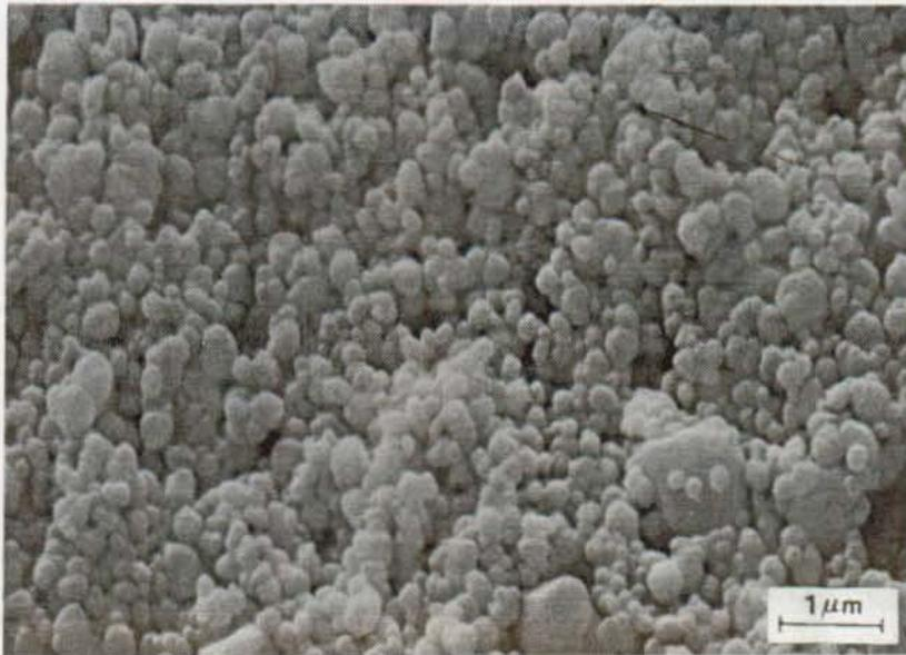
Abbildung 4.3: Elektronenmikroskopie (SEM) einer polykristallinen  $WO_3$ -Elektrode (puratronic).
