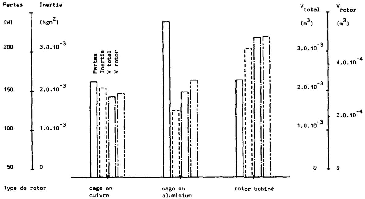
Figure 7.21: machine asynchrone à cage en cuivre, à cage en aluminium, et à rotor bobiné
