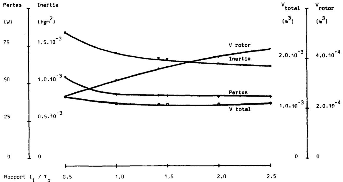
Figure 7.28: machine à courant continu à aimants en SmCo. modification du rapport ( $l_i/\tau_p$ )
