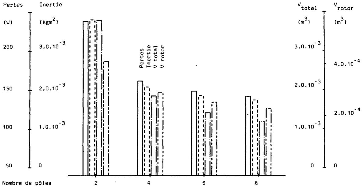
Figure 7.20: machine asynchrone à cage en cuivre, modification de la fréquence d'alimentation (et donc du nombre de pôles)
