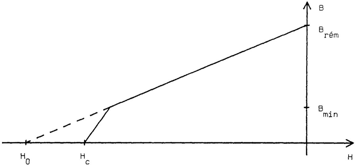
Figure A2.1: approximation de la caractéristique magnétique des aimants permanents
