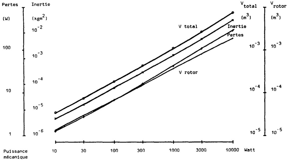
Figure 7.33: machine à courant continu à aimants en SmCo, modification de la puissance mécanique
