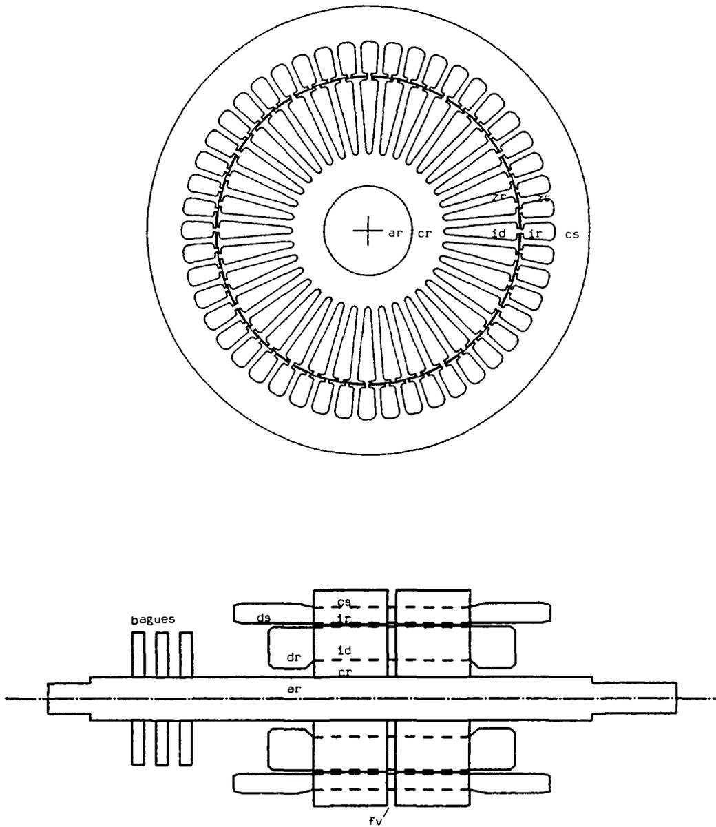
Figure A1.3: Sections longitudinale et transversale d'une machine asynchrone à rotor bobiné
