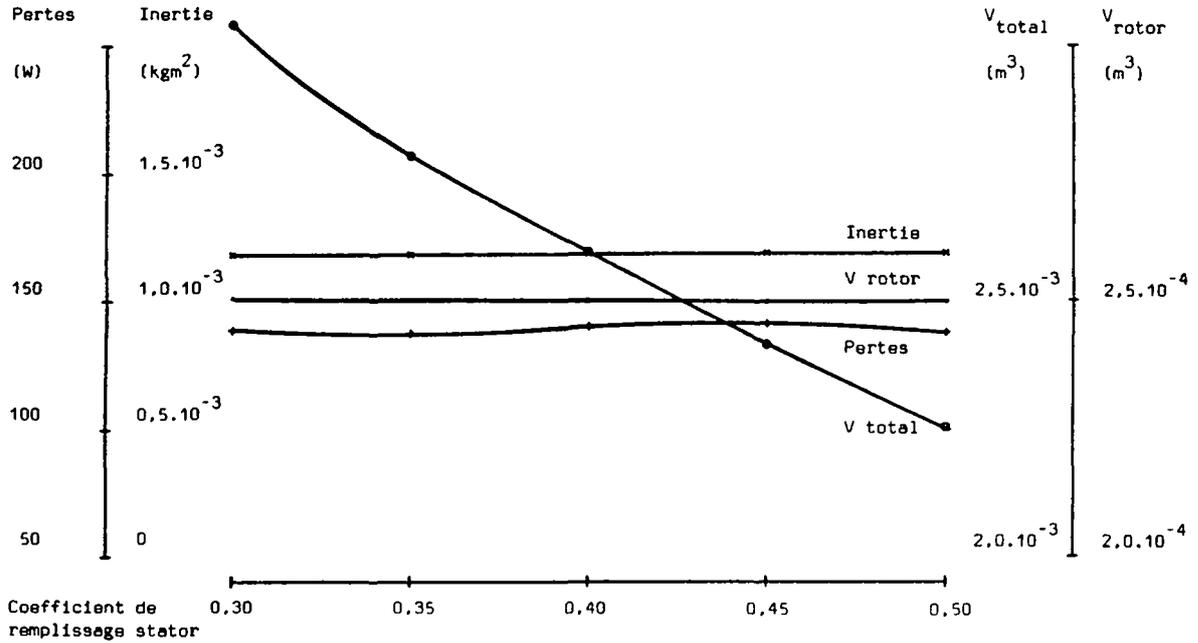
Figure 7.16: machine à aimants en SmCo, modification du coefficient de remplissage des encoches statoriques
