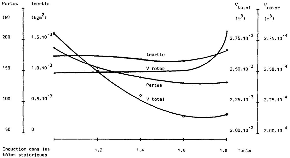
Figure 7.17: machine à aimants en SmCo, modification de l'induction de crête dans les tôles statoriques
