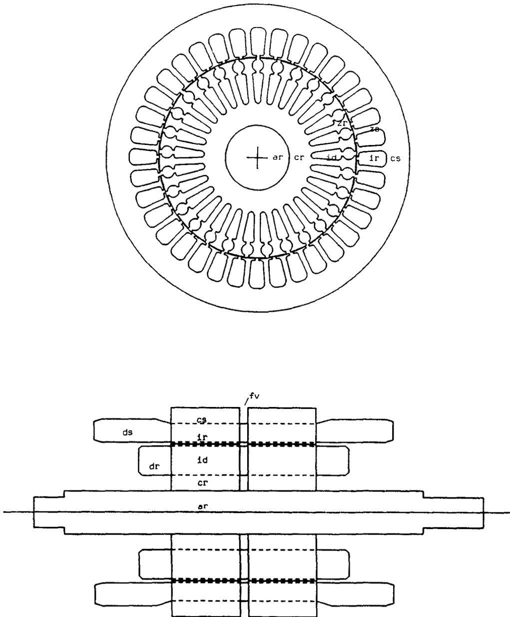
Figure A1.4: Section transversale d'une machine asynchrone à double cage.
