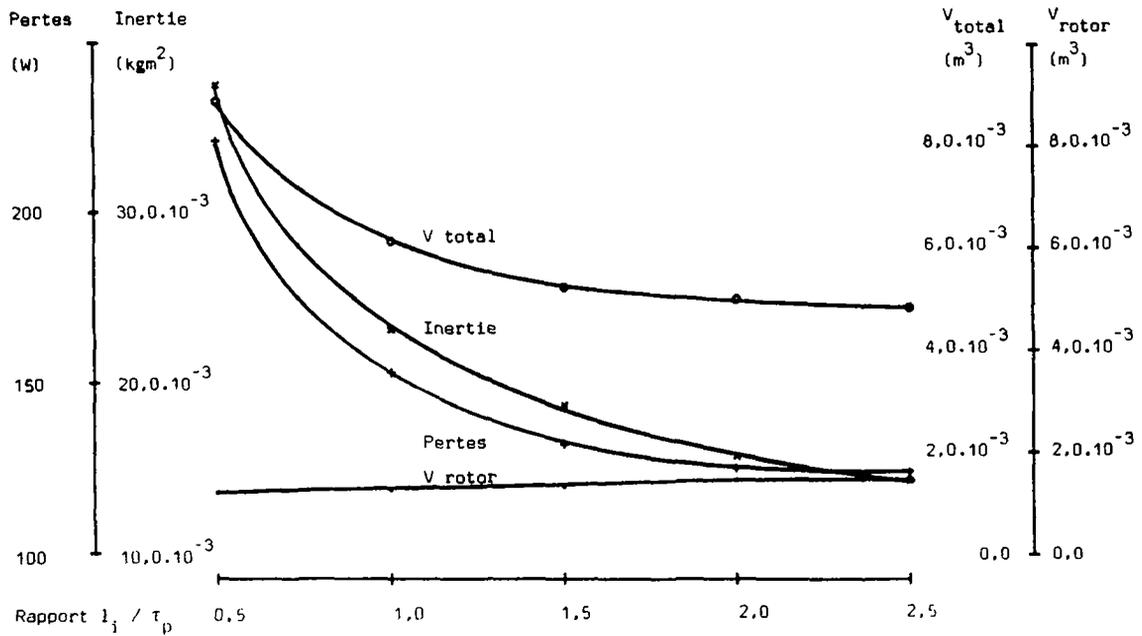
Figure 7.12: machine à rotor lisse et excitation par bobinages, caractéristiques en fonction du rapport ( $l_i / \tau_p$ )
