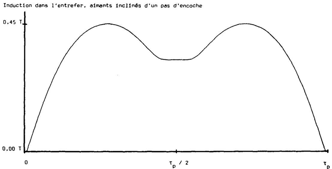
Figure 7.6: induction dans l'entrefer générée par des aimants inclinés
