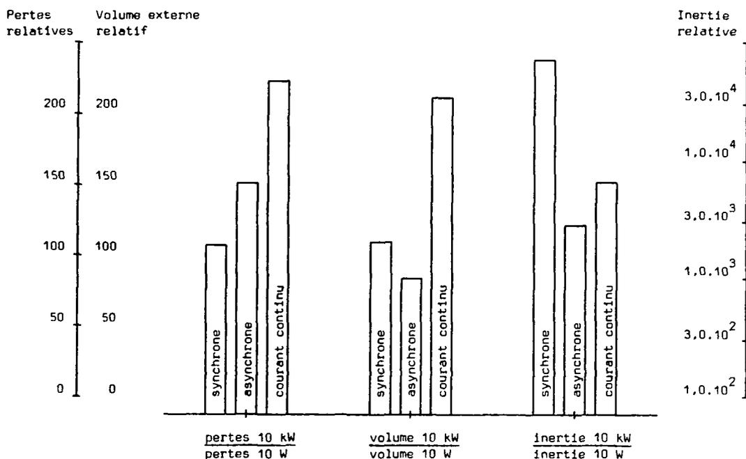
Figure 7.34: dimensions de moteurs de 10 kW rapportées à celles de machines de 10 W
