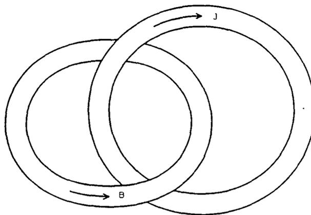
Figure 3.1: imbrication des phénomènes électriques et magnétiques
