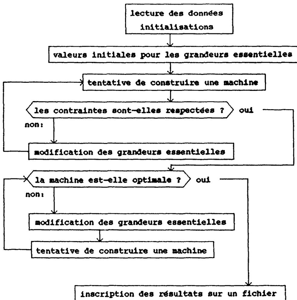
Figure 4.1: structure générale d'un programme calculant les dimensions géométriques de machines électriques
