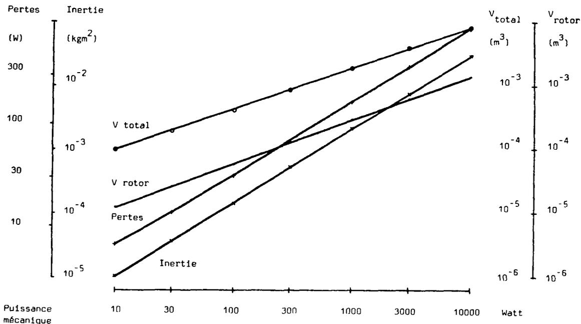
Figure 7.27: machine asynchrone à cage en cuivre, modification de la puissance mécanique
