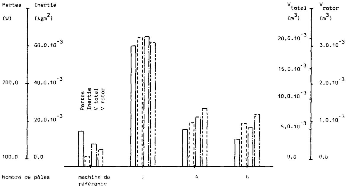
Figure 7.14: machine à pôles saillants et excitation par bobinages, modification de la fréquence d'alimentation (et du nombre de pôles)
