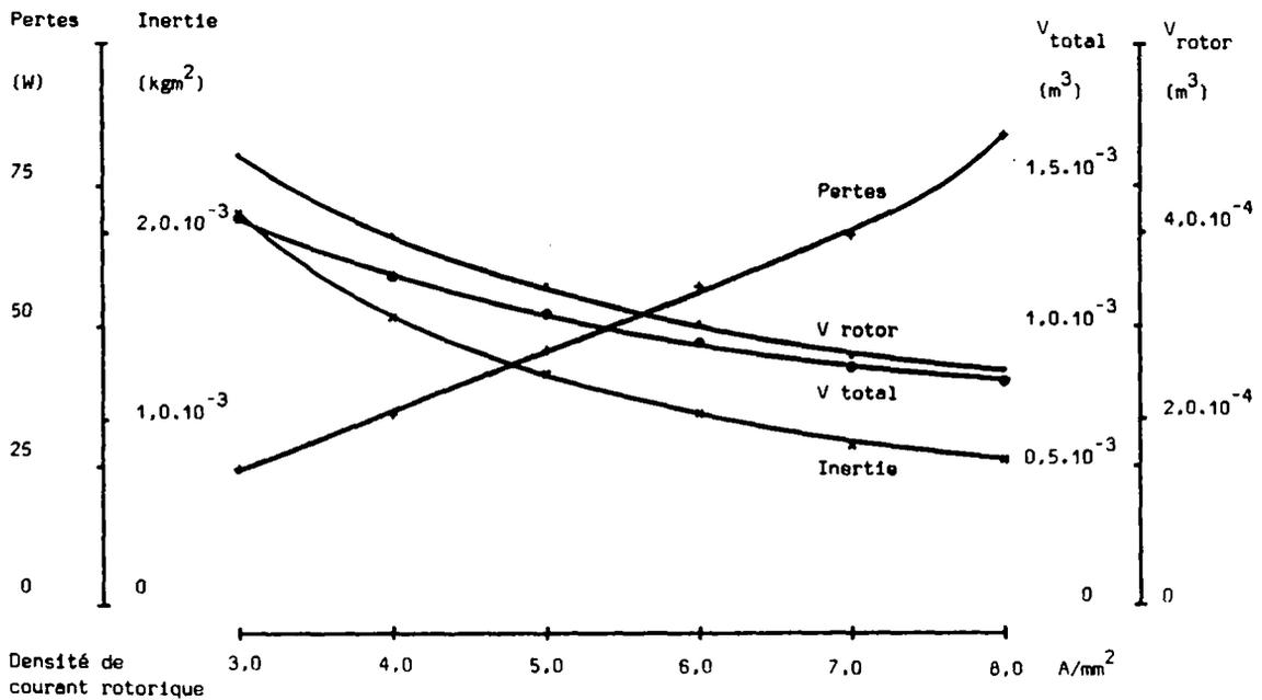
Figure 7.31: machine à courant continu à aimants en SmCo, modification de la densité de courant rotorique
