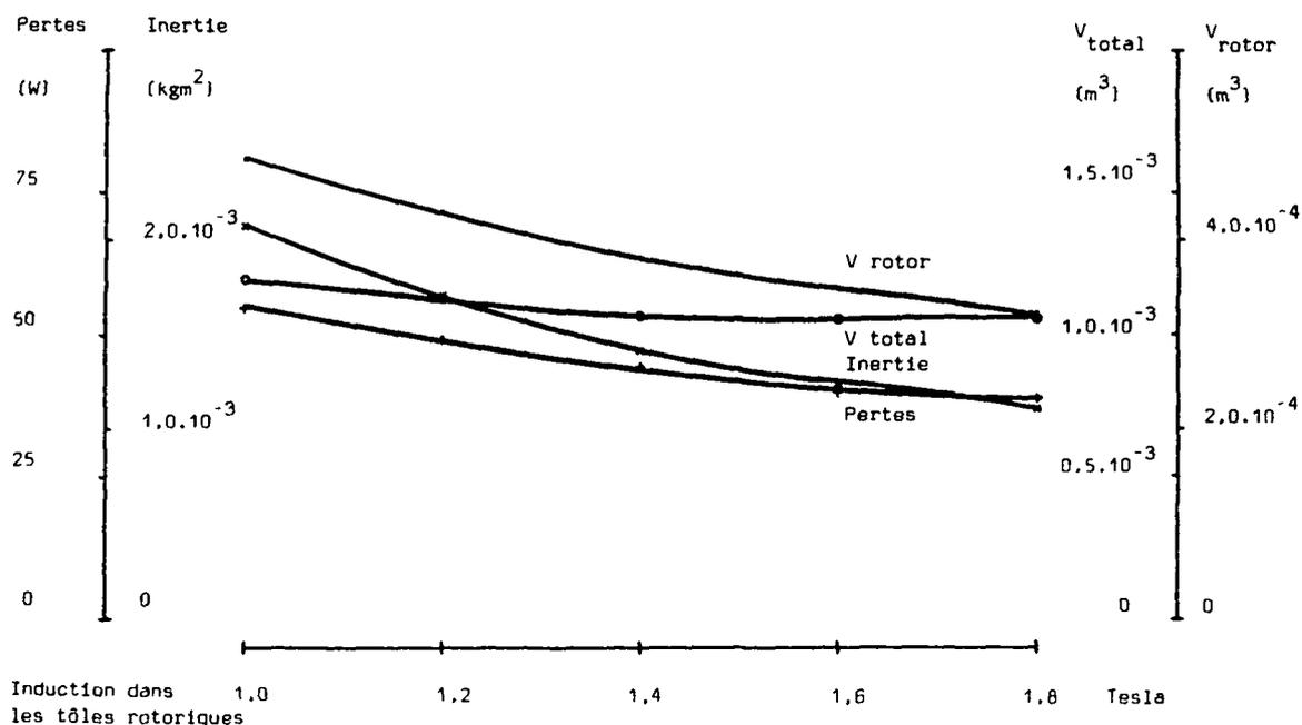
Figure 7.32: machine à courant continu à aimants en SmCo, modification de l'induction maximale dans les tôles rotoriques
