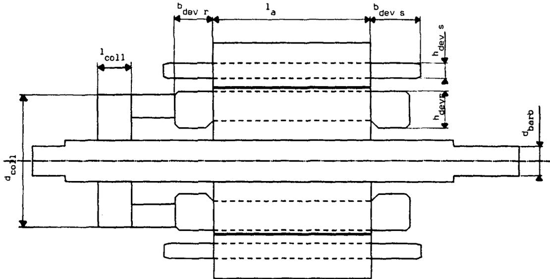
Section longitudinale d'une machine (à courant continu)
