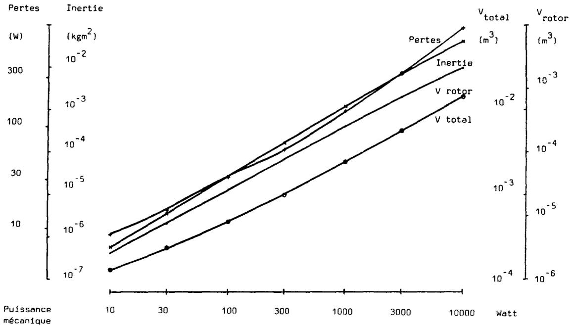
Figure 7.18: machine à aimants en SmCo, modification de la puissance mécanique
