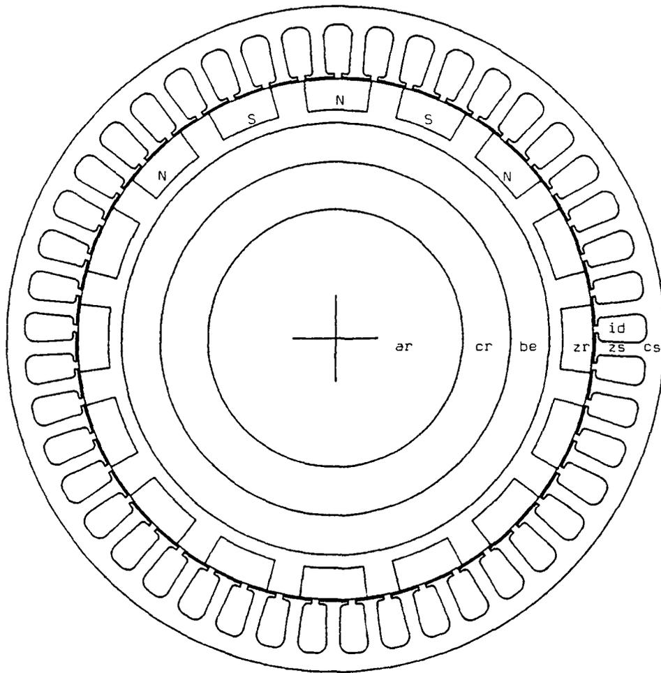
Figure A1.7: Section transversale d'une machine synchrone à rotor à griffes excitée par un bobinage
