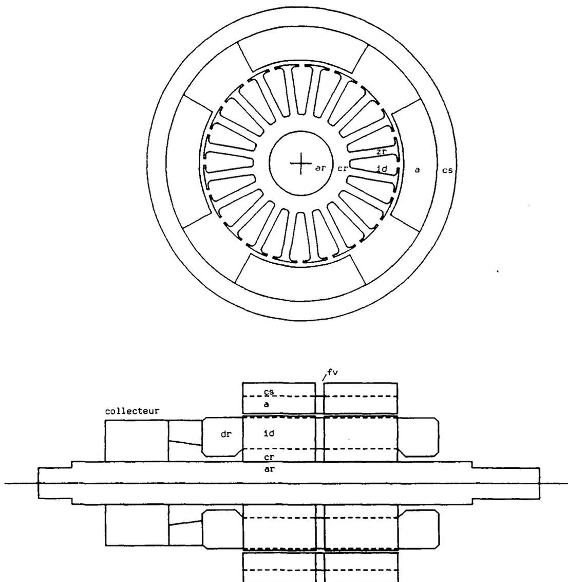
Figure A1.2: Sections longitudinale et transversale d'une machine à courant continu excitée par des aimants cylindriques
