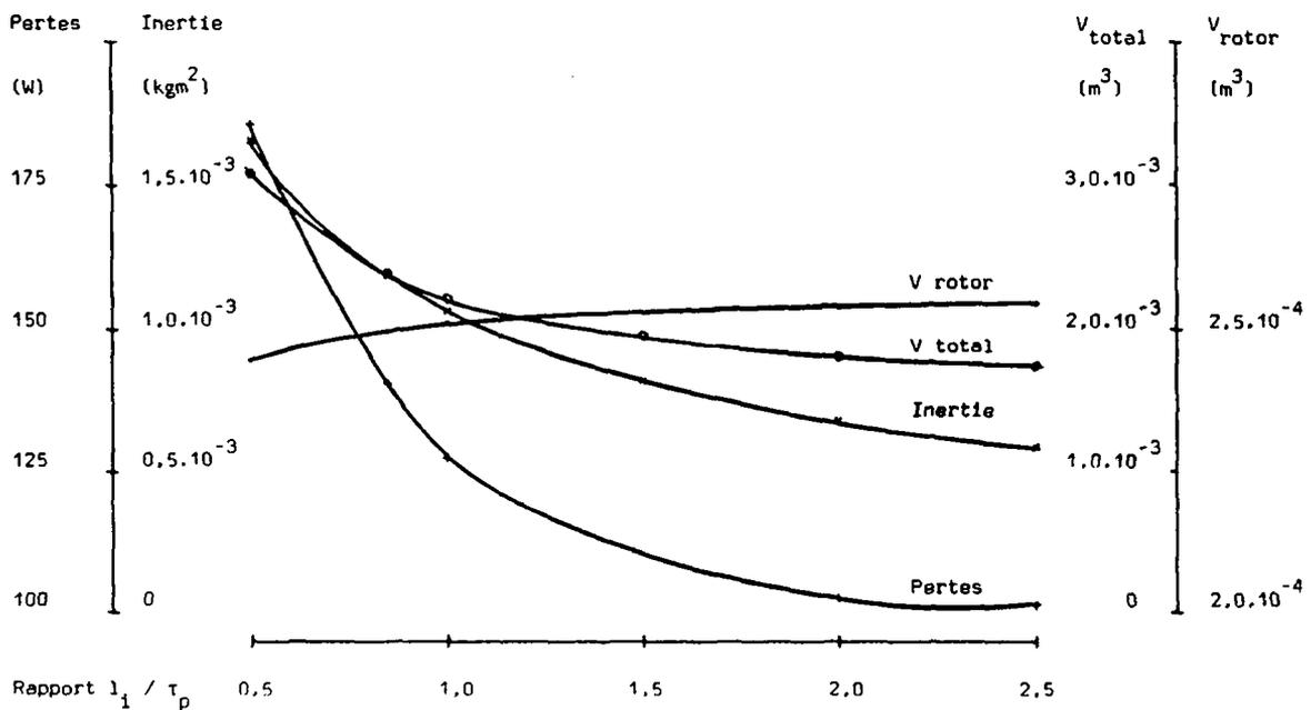
Figure 7.8: machine synchrone à aimants en SmCo, modification du rapport  $(l_i/\tau_p)$
