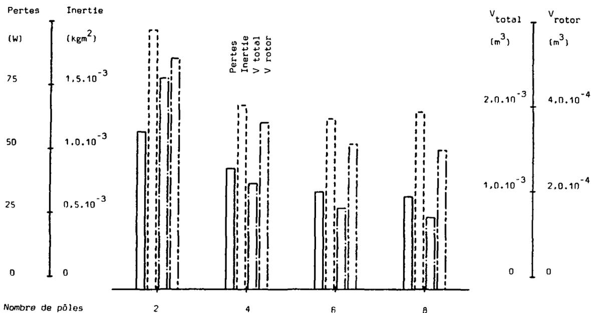
Figure 7.29: machine à courant continu à aimants en SmCo, modification du nombre de pôles
