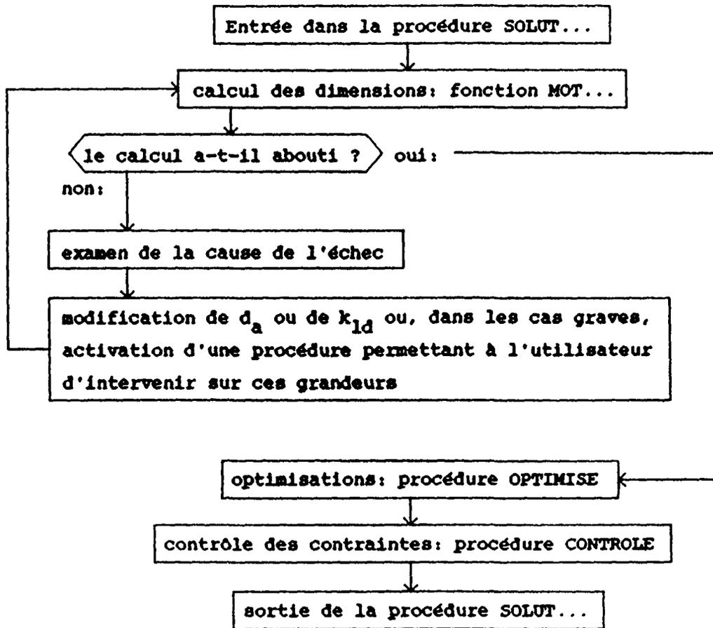
Figure A6.2: organigramme type des procédures SOLUTSYNC, SOLUTASYNC ou SOLUTCC
