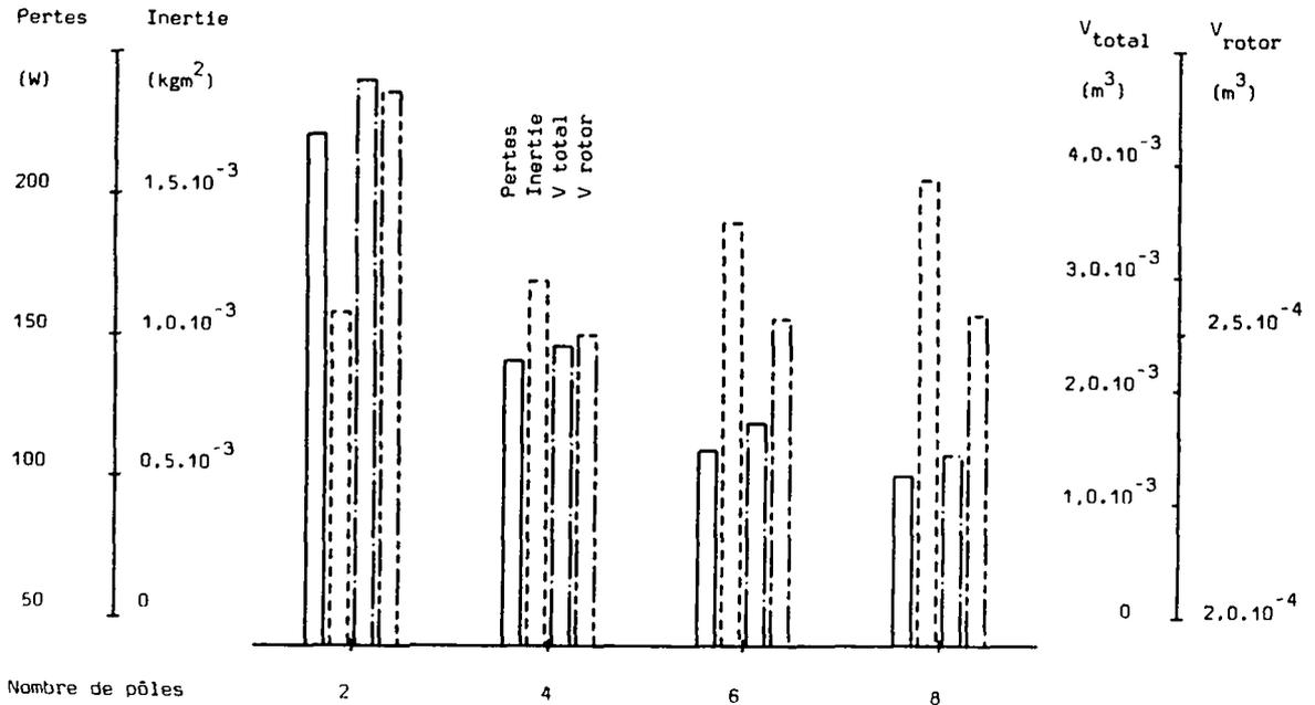
Figure 7.11: machine synchrone à aimants en SmCo, modification de la fréquence d'alimentation (et du nombre de pôles)
