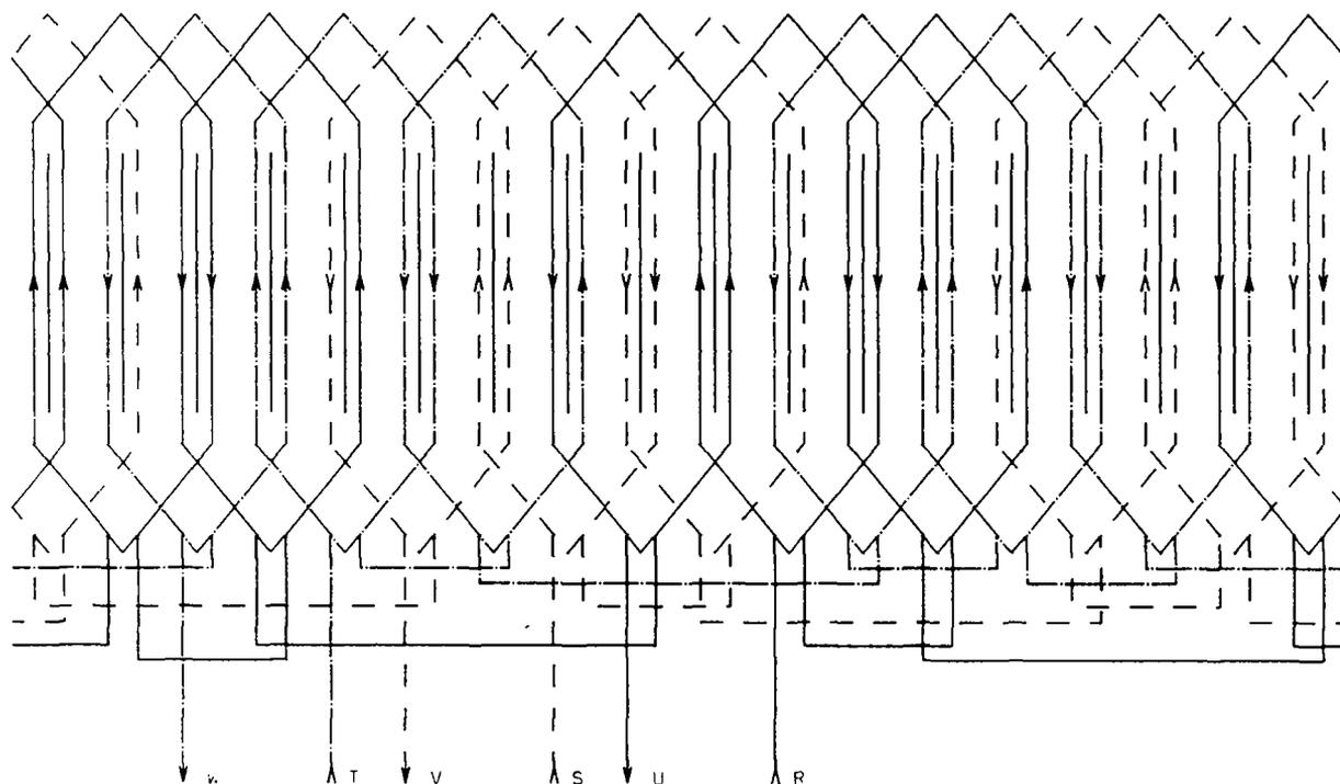
Figure 7.4: schéma de bobinage du stator
