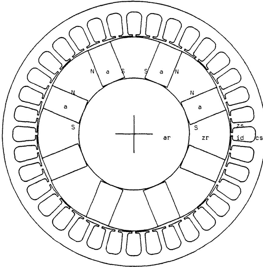
Figure A1.8: Section transversale d'une machine synchrone à aimants radiaux
