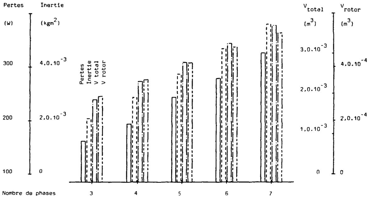
Figure 7.22: machine asynchrone à cage en cuivre, modification du nombre de phases
