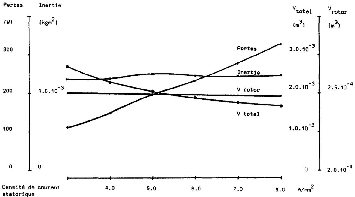
Figure 7.15: machine à aimants en SmCo, modification de la densité de courant efficace au stator
