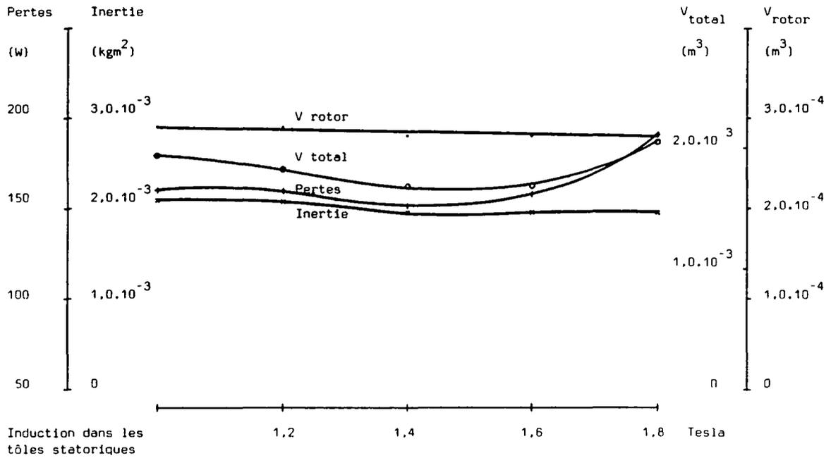
Figure 7.25: machine asynchrone à cage en cuivre, modification de l'induction dans les tôles statoriques
