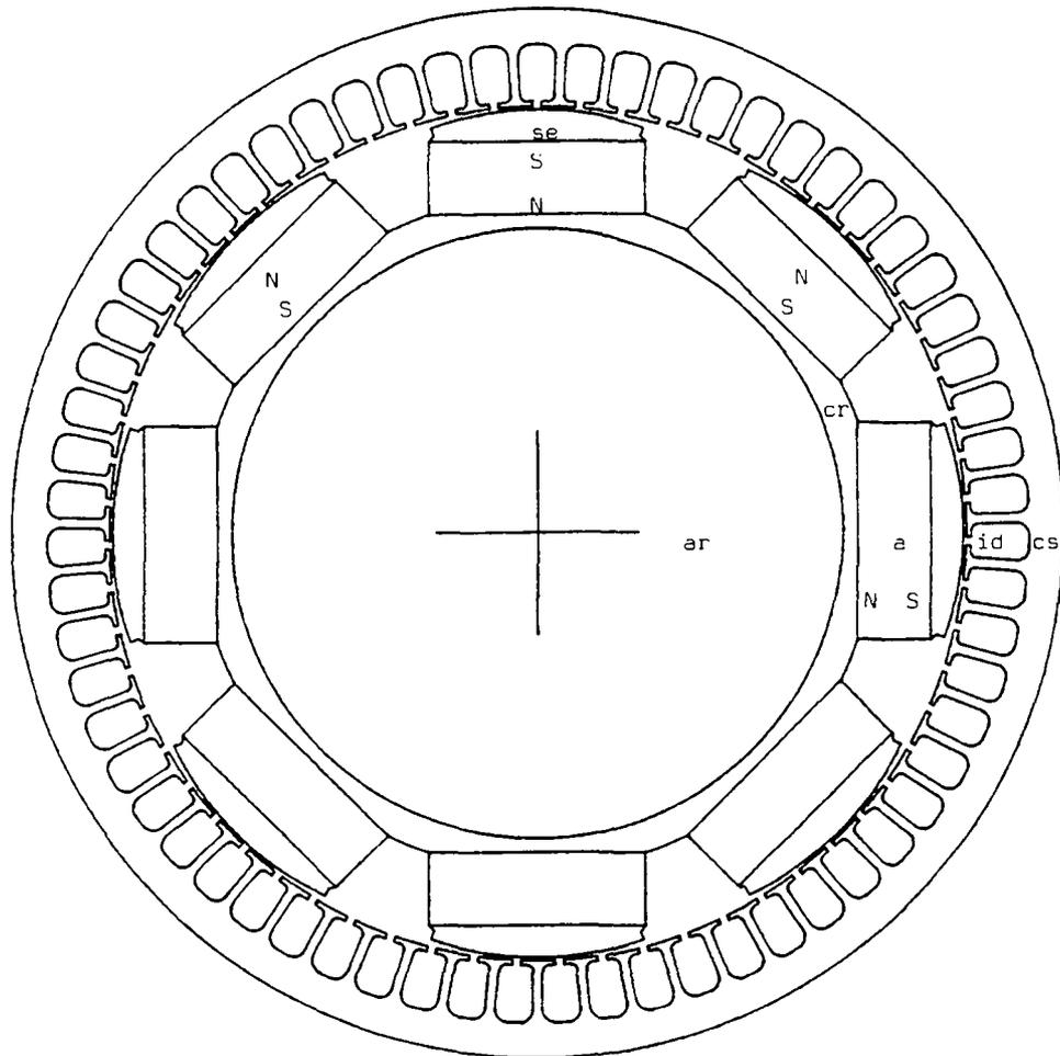
Figure A1.9: Section transversale d'une machine synchrone à aimants couverts
