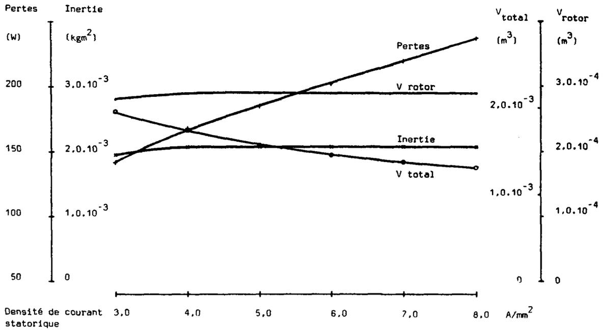
Figure 7.23: machine asynchrone à cage en cuivre, modification de la densité de courant statorique
