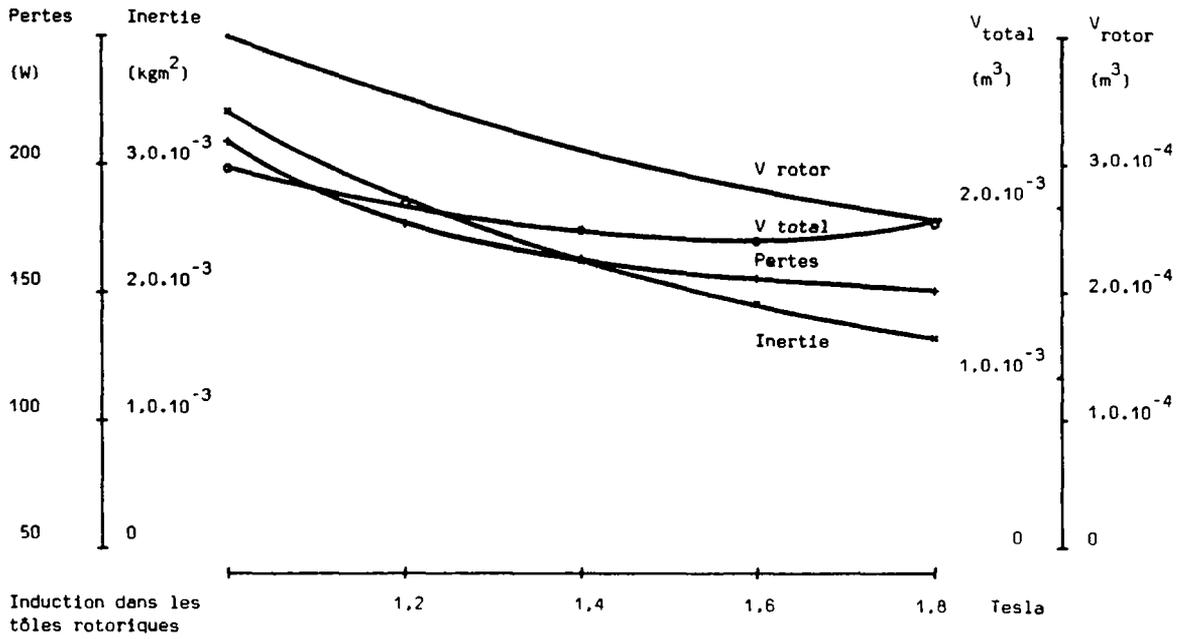
Figure 7.26: machine asynchrone à cage en cuivre, modification de l'induction dans les tôles rotoriques
