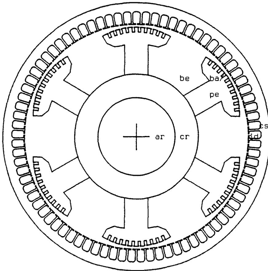
Figure A1.6: Section transversale d'une machine synchrone à pôles saillants et amortisseur
