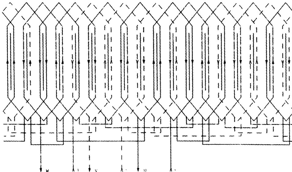
Figure A7.2: schéma de bobinage correspondant.
