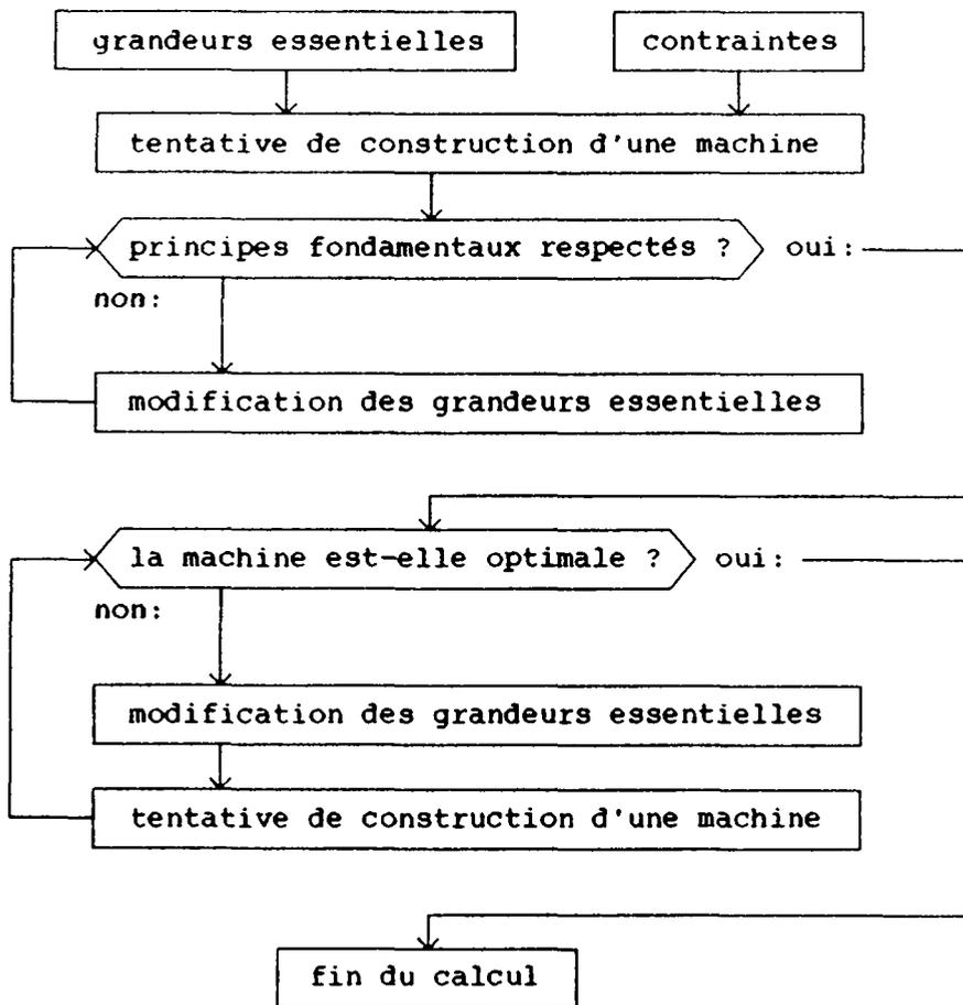
Figure 1.1: principe de dimensionnement d'un moteur électrique
