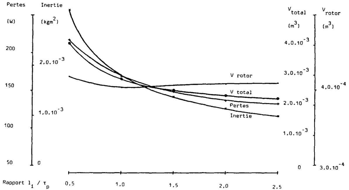
Figure 7.9: machine synchrone à aimants en ferrite, modification du rapport ( $l_i / \tau_p$ )
