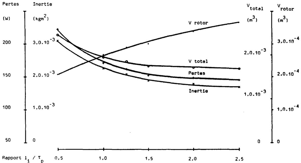
Figure 7.19: machine asynchrone à cage en cuivre, modification du rapport  $(l_1/\tau_p)$
