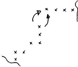
Fig.3.7 Les deux pointeurs ont un parcours commun avant l'occurrence d'un trou. Chacun peut alors tenter l'interpolation.
