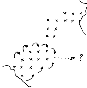
Fig.3.8 Les pointeurs se déplacent en sens opposé à l'approche d'un trou. Il faut alors extrapoler dans la direction du squelette.
