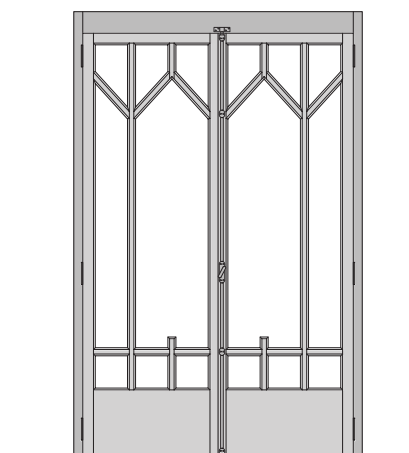
Dessin de la porte-fenêtre de la véranda (actuelle), 1:10 (réduction)
