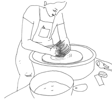
La tête, le corps et la main centrant l'argile au tour
