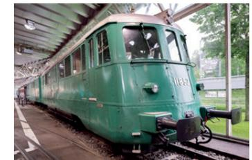
fig.7 Locomotive électrique double Ae 8/14 no 11852 CFF 1939
