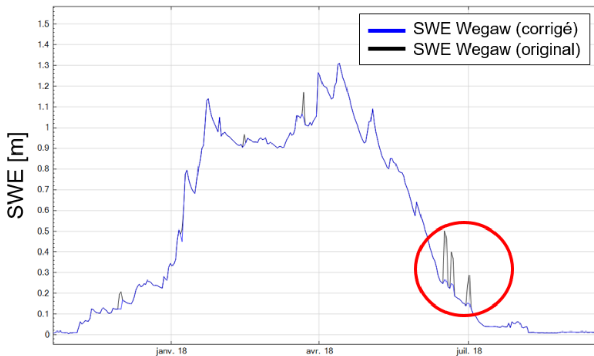
Figure 36 : Exemple de correction de pics en fin de saison pour le SWE mesuré à Kummenbord pour l'année 2017-2018.
