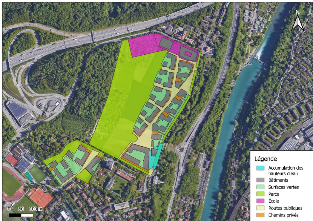
Figure 15 Accumulation des hauteurs d'eau dans les sous-bassins urbains avant construction
