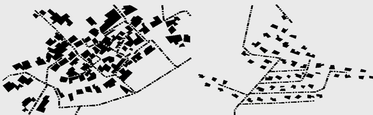
Figure 2 : Vision schématique du centre historique d'Apples (gauche) et du quartier périphérique d'En Lèvremont (droite). Les pointillés correspondent aux principaux collecteurs du réseau des égouts.
