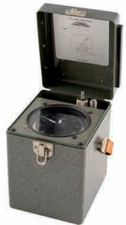
Baromètre anéroïde de précision Aluminium, verre, acier, Revue Thommen, Suisse, vers 1970 Musée d'histoire des sciences Baromètre utilisé pour vérifier les hauteurs de mercure mesurées
