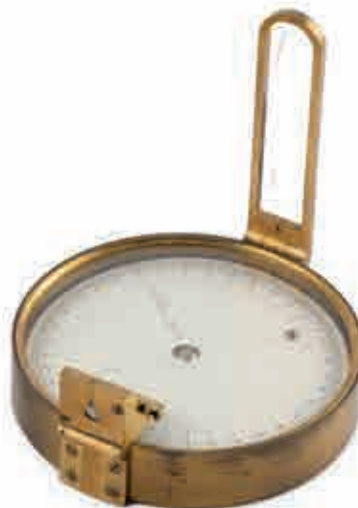
Boussole d'arpentage MHS 23 Laiton, verre, acier, Noblet, Genève, vers 1830 Musée d'histoire des sciences
