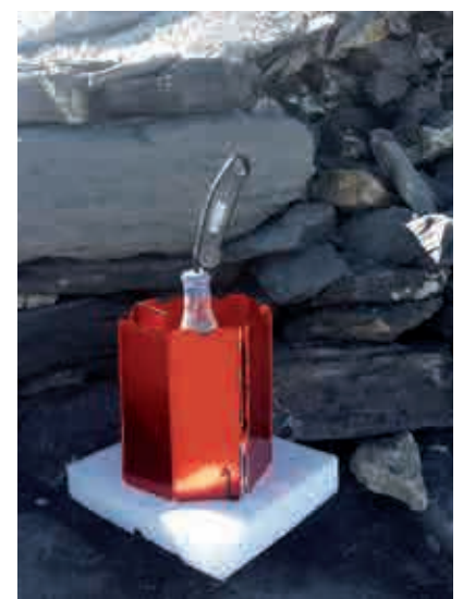
Dispositif expérimental pour mesurer la température d'ébullition de l'eau ©Musée d'histoire des sciences
