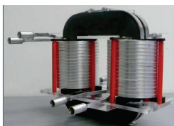
FAU-EN: 450kW, 5.6kHz
