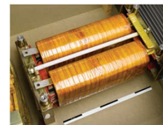
IKERLAN: 400kW, 5kHz
