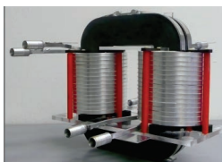
FAU-EN: 450kW, 5.6kHz
