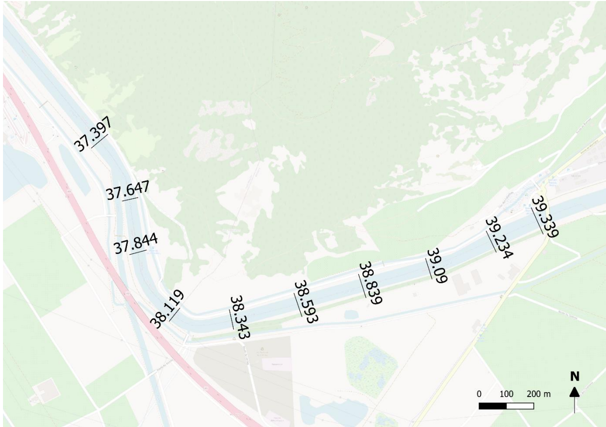
Figure 4: Carte des profils du Rhône avec leur kilométrage sur lesquels la modélisation est appliquée
