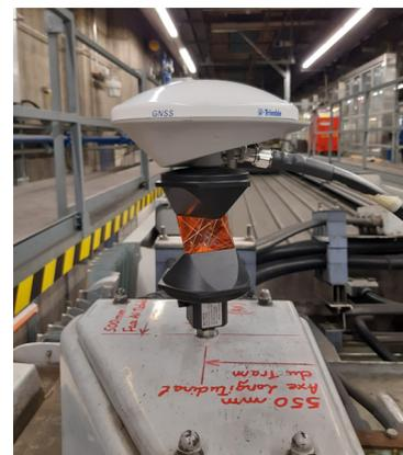
**Figure 3.8** – Photo de l'antenne GNSS au-dessus du prisme ancré au toit du tram
