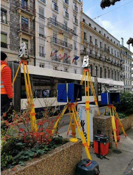
**Figure 3.7** – Photo de la configuration des deux théodolites à rue de la Terrassière à Genève
