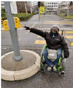
Figure 139 Bouton de commande non accessible, Grand-Lancy
