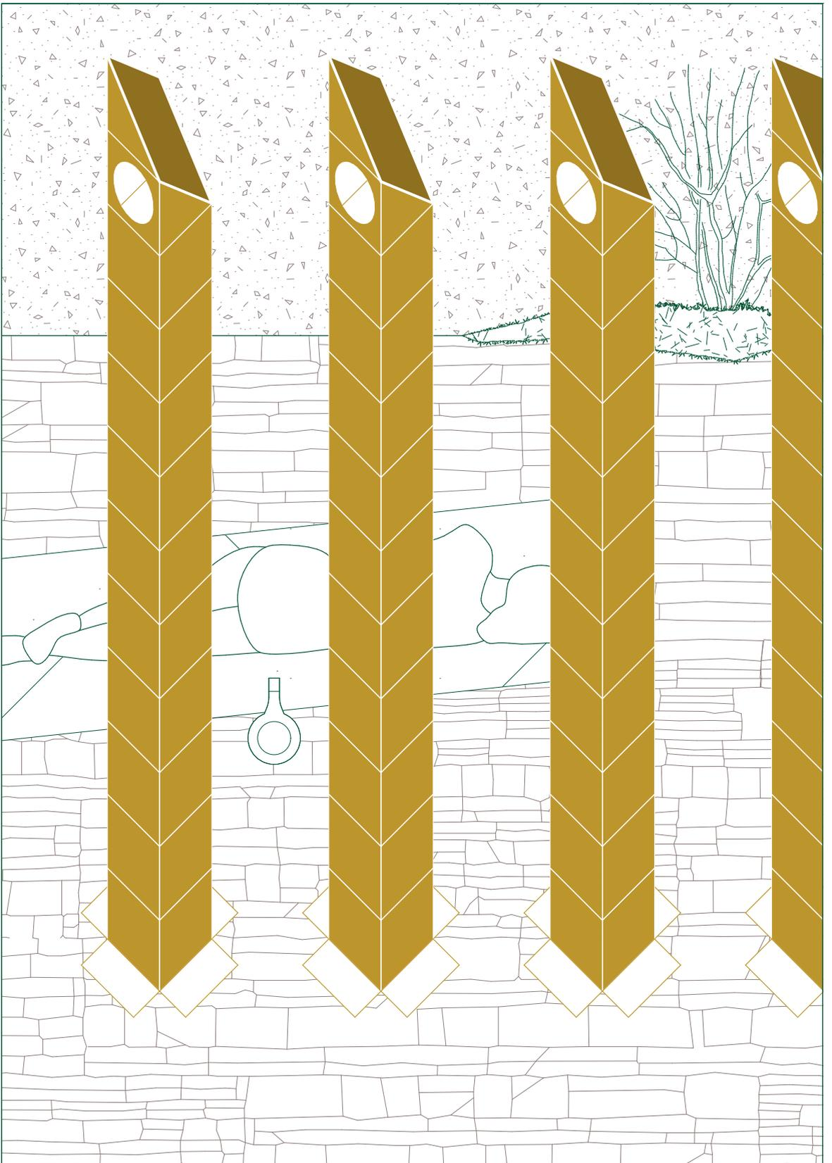
**Cheminée** · Les conduits en terre cuite percent la dernière dalle et traversent le solarium pour évacuer les fumées par-dessus la toiture.
