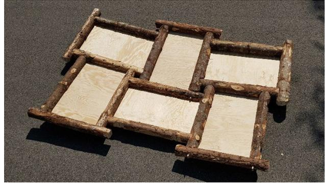
Figure 60: Projet de recherche mené par Petras Vestartas à l'Ibois, EPFL. Ce prototype fait partie de l'étude de cas End-Side Joints, qui combine un maillage de rondins de bois avec des panneaux de contreventement.
