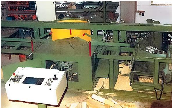
Figure 5: Première machine de découpe pour le bois pilotable par ordinateur Hundegger P8 (1985)
