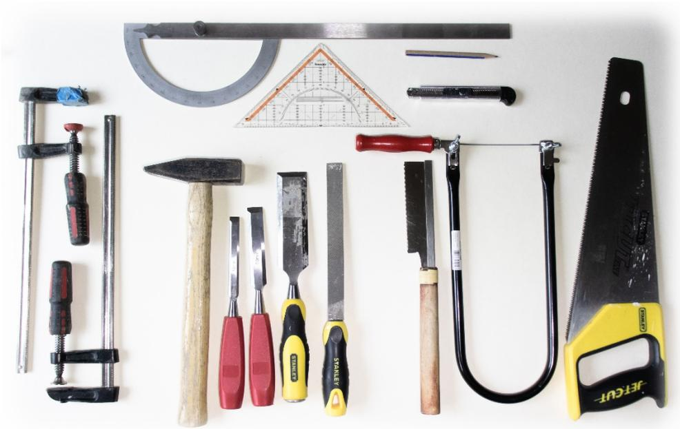
Figure 23: Les outils utilisés pour la découpe manuelle de l'assemblage Ari-kake
