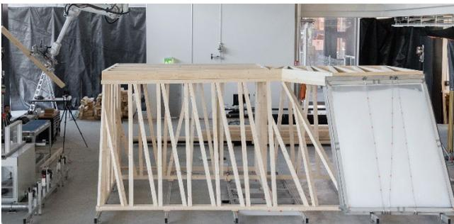
Figure 9: Prototype de RFL assemblé par des bras robotiques
