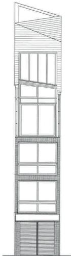
Ici en élévation un étage est une pièce que l'escalier échelonne, passant d'abord par le commerce, puis la cuisine, le salon, la chambre et le loft. Les pièces principales sont donc mono-orientées sachant que l'arrière est dédié à la distribution verticale et aux sanitaires.
